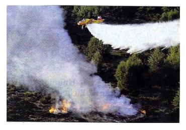
Die Feuerwehr kann auch Feuer aus der Luft löschen, dazu verwenden sie Flugzeuge und Hubschrauber, die mit großen Wassertanks ausgestattet sind.
